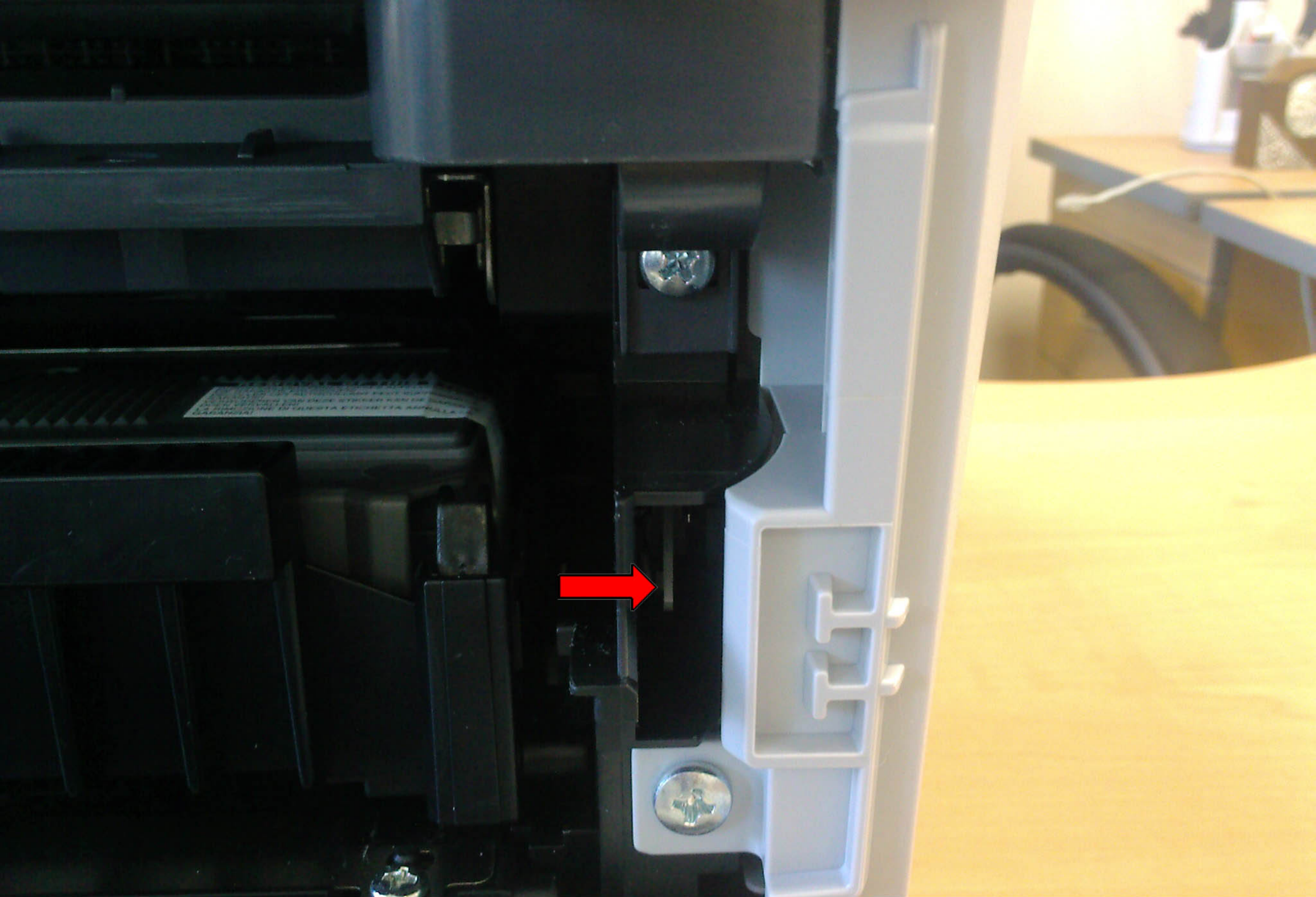
Рис.5 Нажать и удерживать датчик открытия крышки
