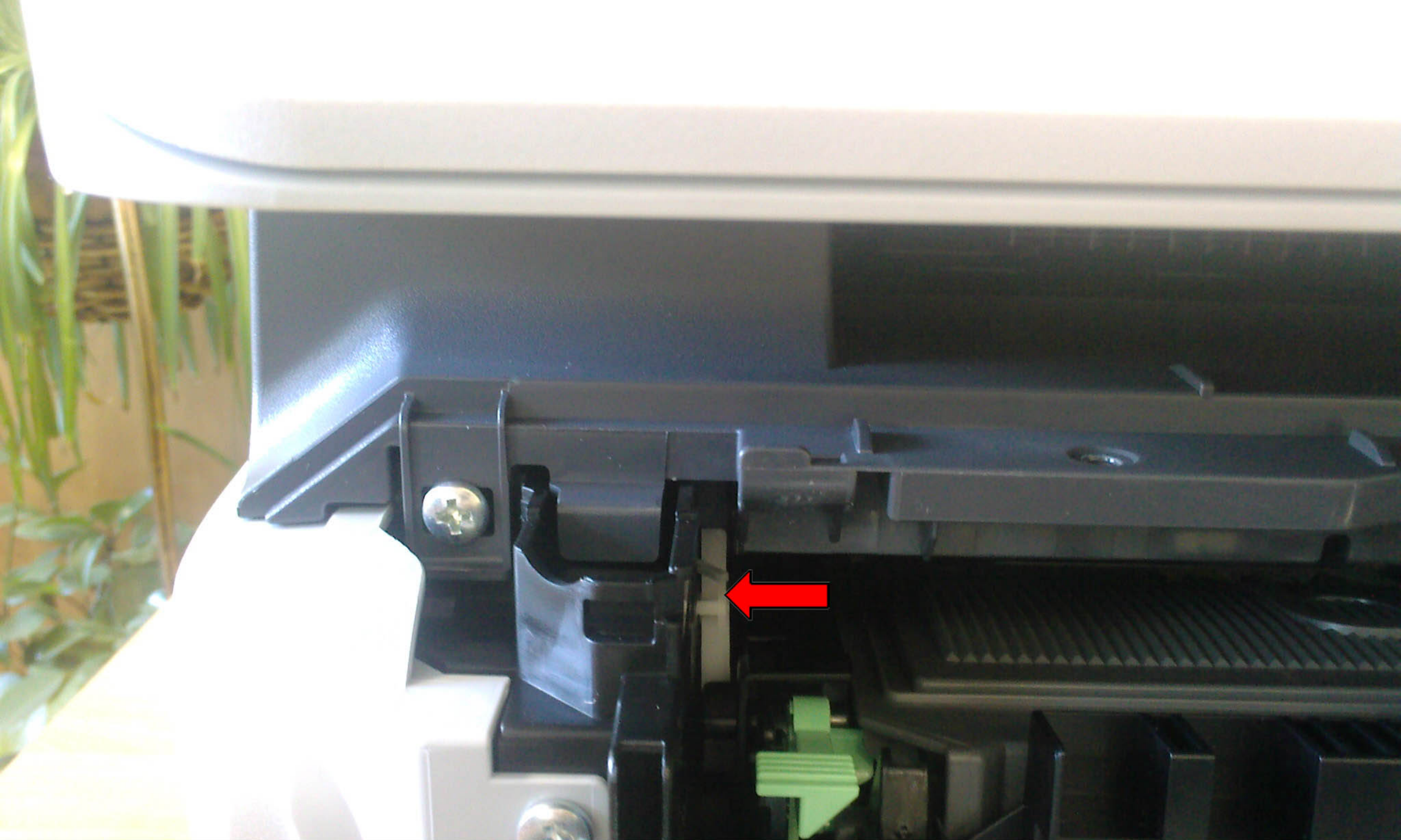
Как только начнётся вращение основного мотора принтера (слышим работу двигателя и характерный щелчок), отпускаем датчик нового тонера, при этом удерживая датчик открытия крышки
